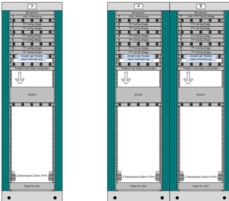
Beispiele für ein oder zwei 19“ Standverteiler (schematisch)
