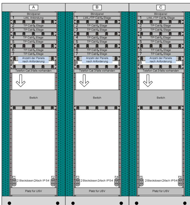
Beispiel für drei 19“ Standverteiler (schematisch)
