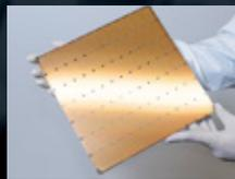
850.000 Rechenkerne sammeln sich auf dem Chip des CS-2-Systems, das auf maschinelles Lernen spezialisiert ist und welches das LRZ für seine AI Systems kauft.
